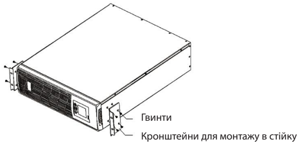
Мал. 3.2.4.3 Встановлення кронштейнів для монтажу в стійку
