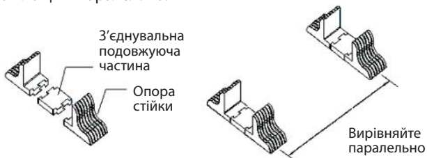
Мал. 3.2.4.2 Схема монтажу опорних елементів
