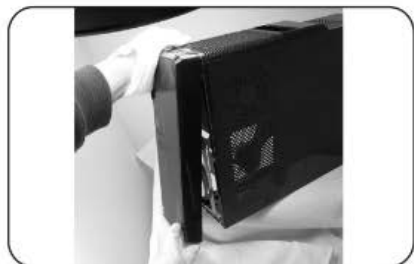
1 – Отсоедините переднюю панель.
