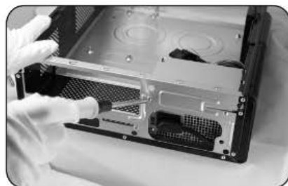
4 – Зафіксуйте блок живлення гвинтами зі сторони передньої панелі.
