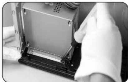
2 – Виверніть два гвинти та встановіть блок живлення в нижню частину корпусу.
