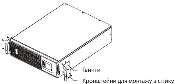
Мал. 3.2.4.3 Встановлення кронштейнів для монтажу в стійку
