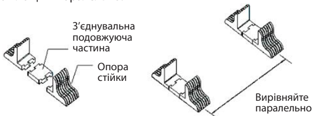
Мал. 3.2.4.2 Схема монтажу опорних елементів
